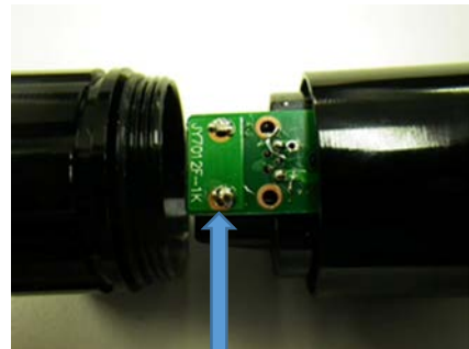
露出した充電部
