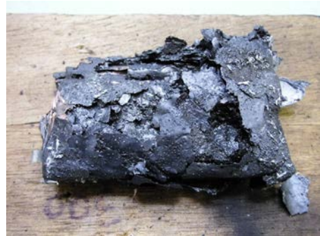
過充電で発火したリチウム電池
