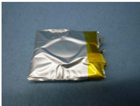
過充電で膨張したリチウム電池
