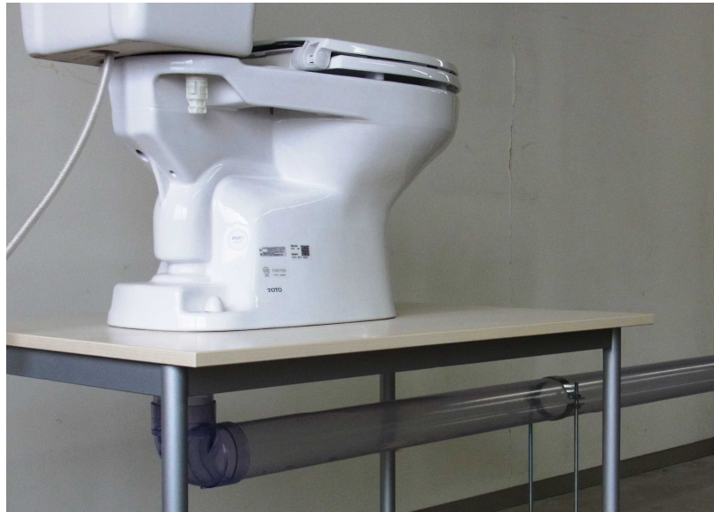
トイレ排水性試験設備
