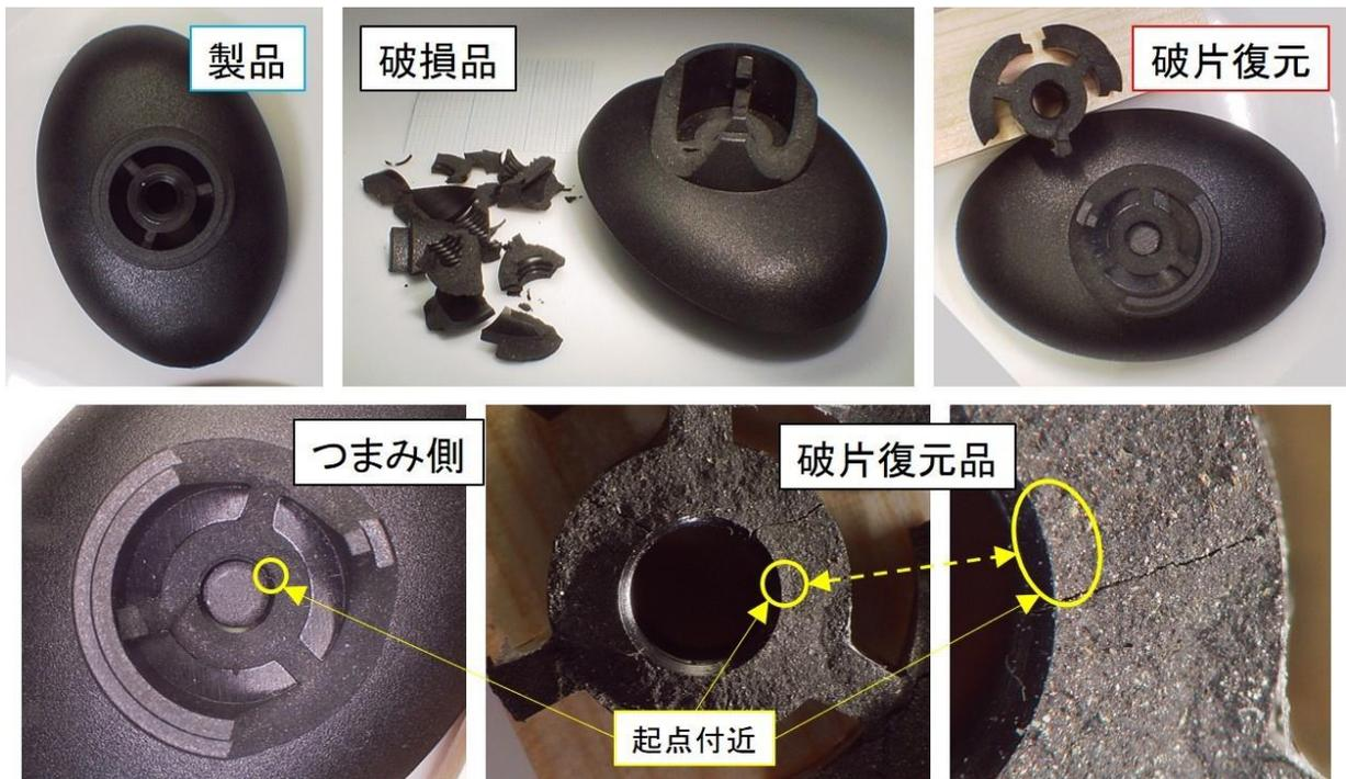
図. フェノール樹脂(PF)製鍋フタのつまみの破損品とその破損解析.
