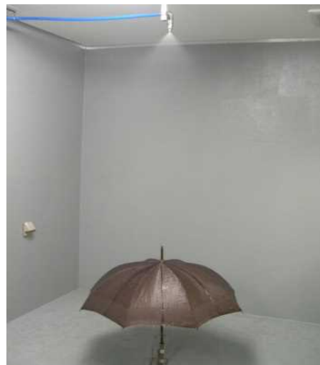
傘の漏水性試験
